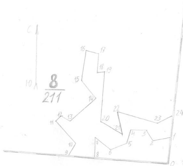
Данные инструментальной съемки границ лесосеки
