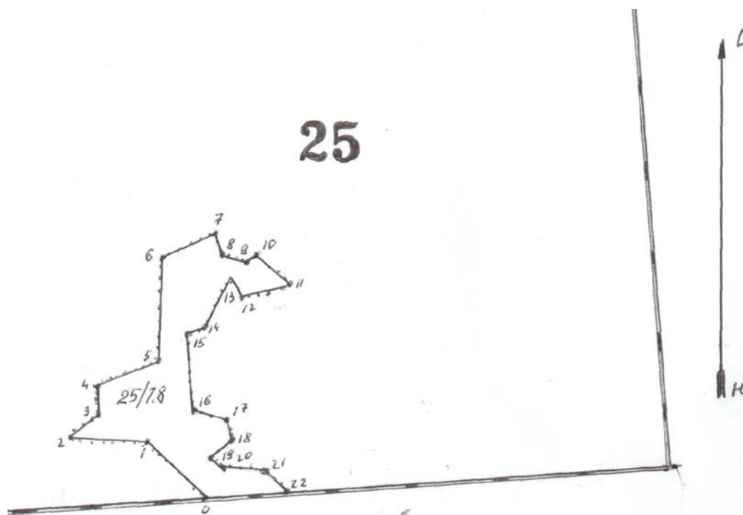
Данные инструментальной съемки границ лесосеки
